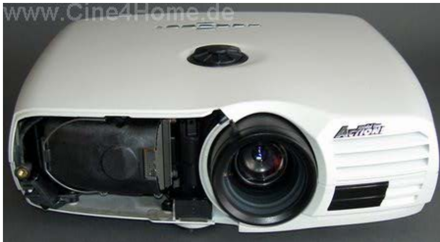
Der Lampeschacht direkt neben der Optik
