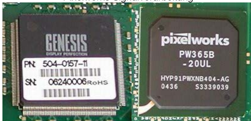
Die Hauptplatine mit Faroudja-De-Interlacer und Pixelworks Signalverarbeitung
