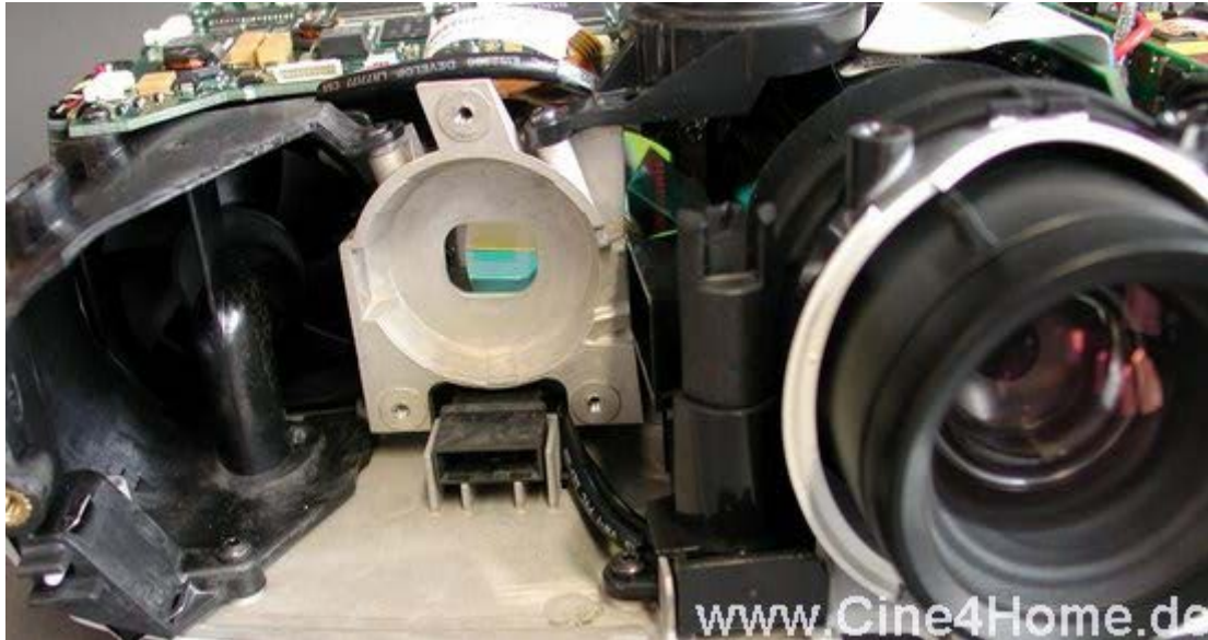
Der Anfang des Lichtweges (oben) mit Farbrad-Fenster
