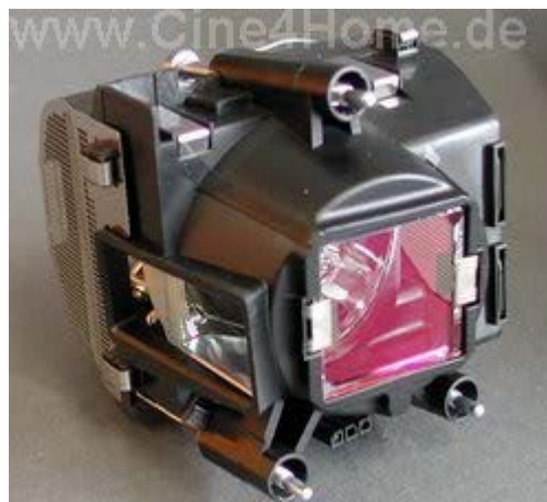
Das kleine Lampenmodul ist gut gekapselt
