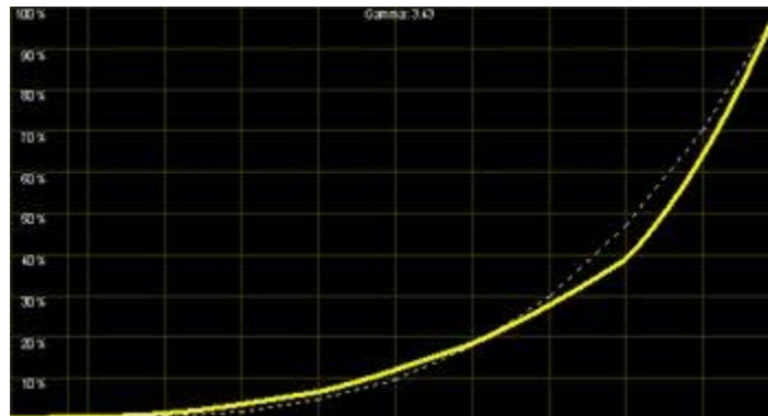
Maximale Weißbetonung: Gammaanstieg von über 3,4 (!!)
