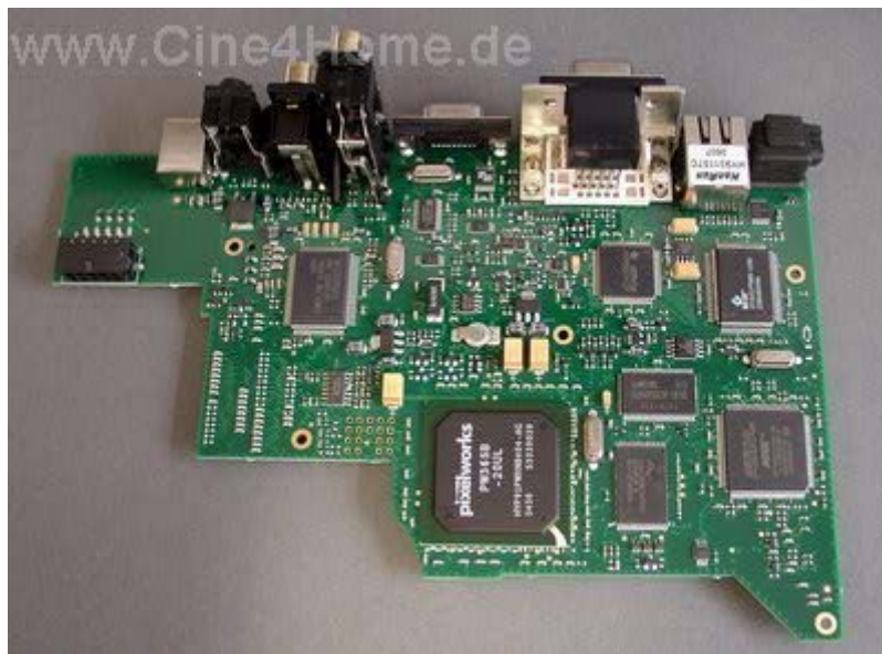
Die Hauptplatine mit Faroudja-De-Interlacer und Pixelworks Signalverarbeitung
