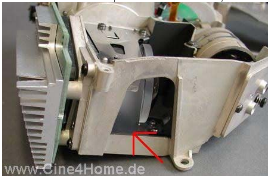
Pfeile: Das Glasprisma vor dem DMD-Chip
