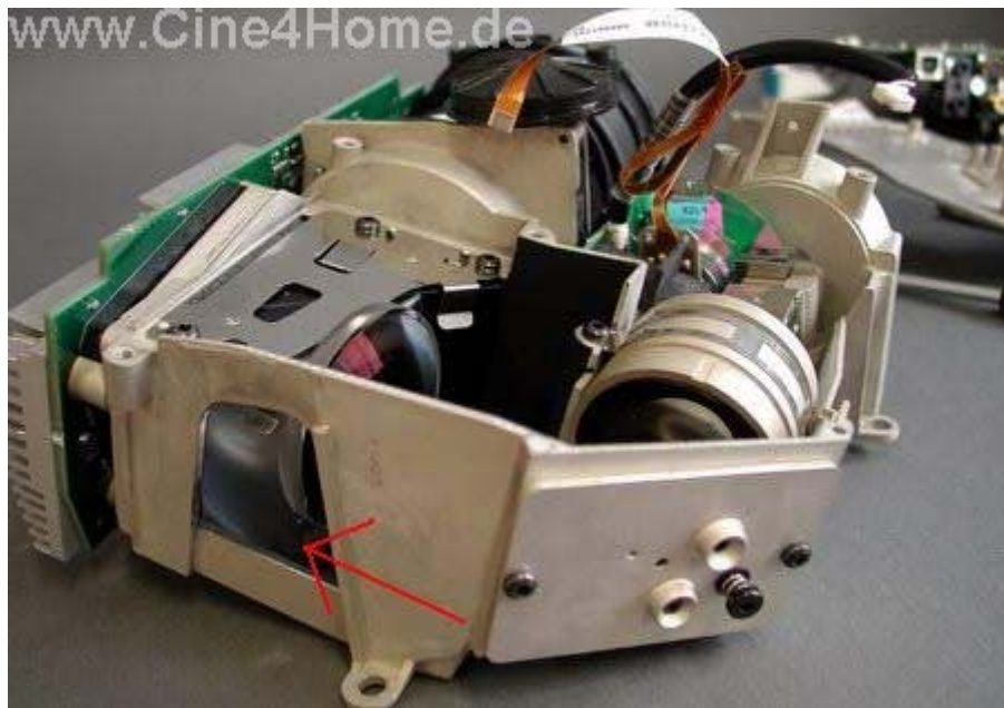
Pfeile: Das Glasprisma vor dem DMD-Chip
