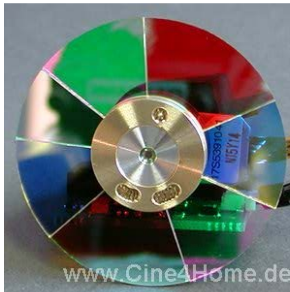
Das spezielle Farbrad des Action! model two
