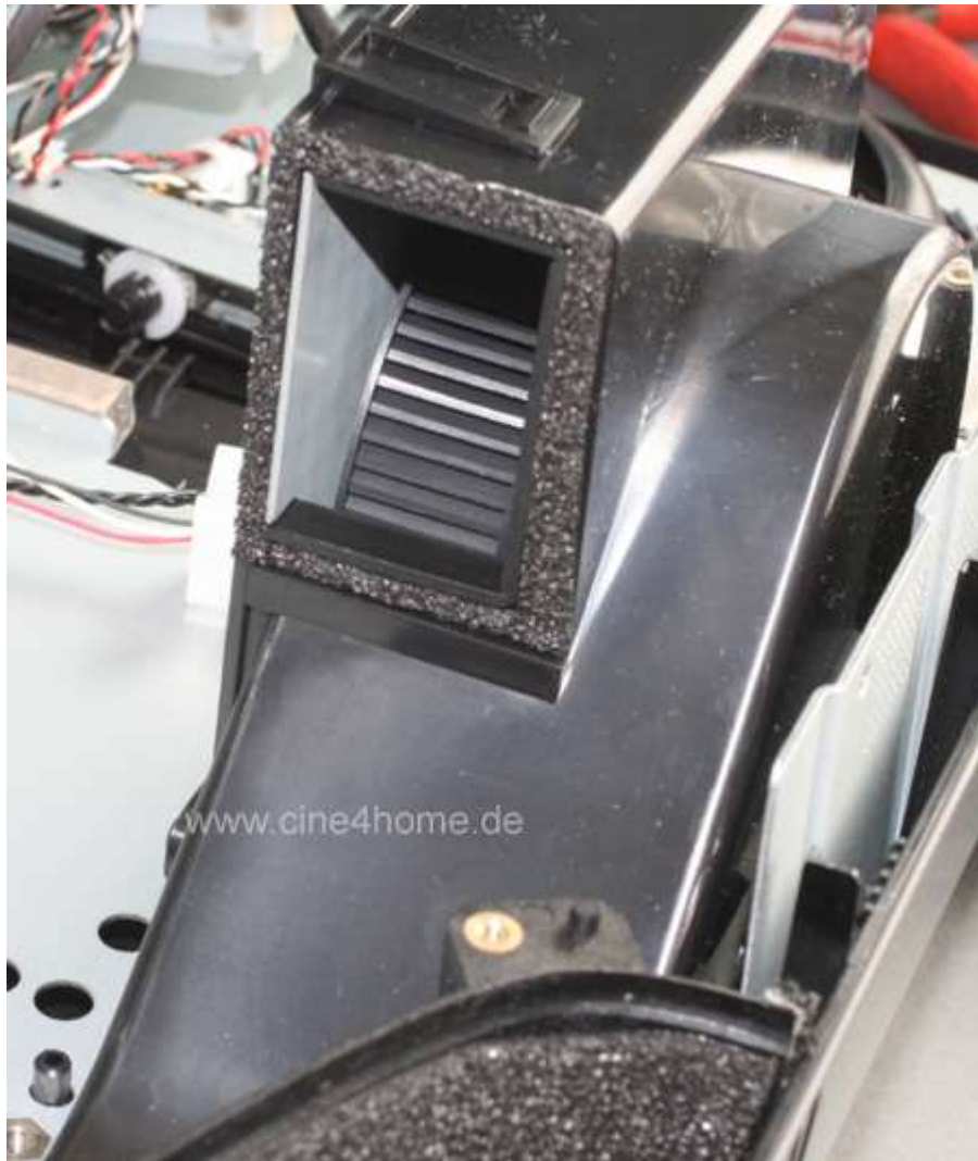
Das Schaufelrad fördert die Luft direkt in die Lightengine
