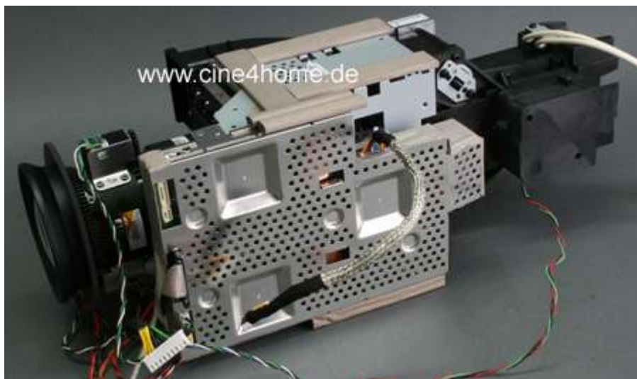
Die Steuerprozessoren der D-ILA Panels werden passiv gekühlt
