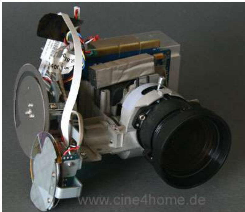
Kompakt und verkapselt: Der kleine Lichtweg der DLPs
