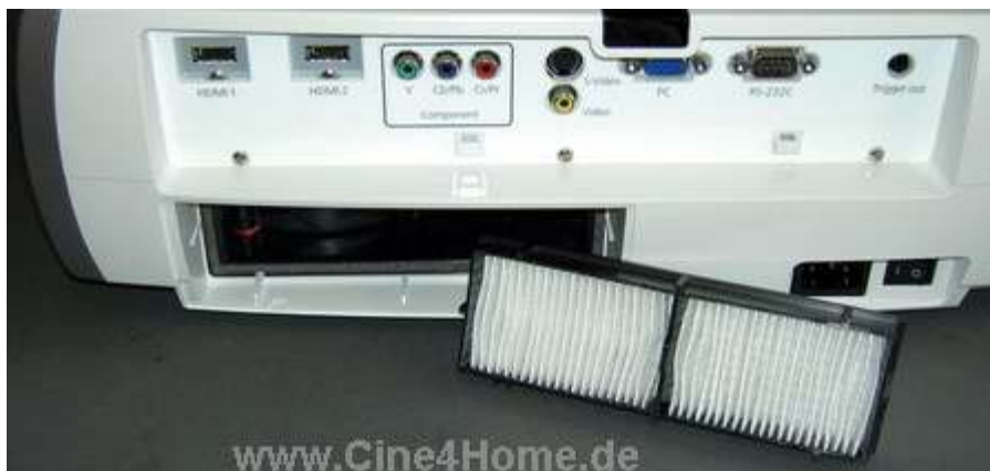
Luftwege und Filter des TW2900
