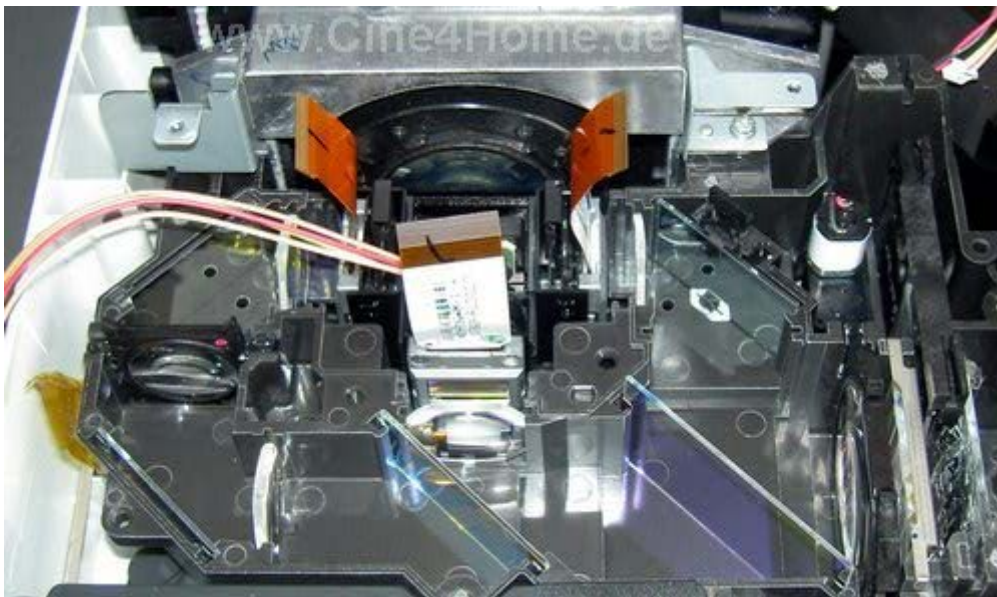
Oben: Der gesamte optische Lichtweg Unten: Die Färbung der Gläser ist deutlich zu erkennen
